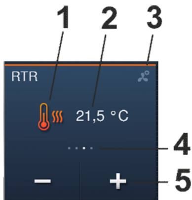
Abb. 8: Übersicht der Bedien- und Anzeigeelemente des Raumtemperaturreglers
