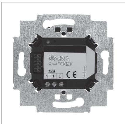
Der Schaltaktor/-sensor ist für die Montage in einer 60 mm Unterputz-Dose nach DIN 49073 vorgesehen. Die Befestigung erfolgt wahlweise mit Schrauben über die Befestigungsbrücke oder schraubenlos mit einem Feder-Befestigungssystem.
